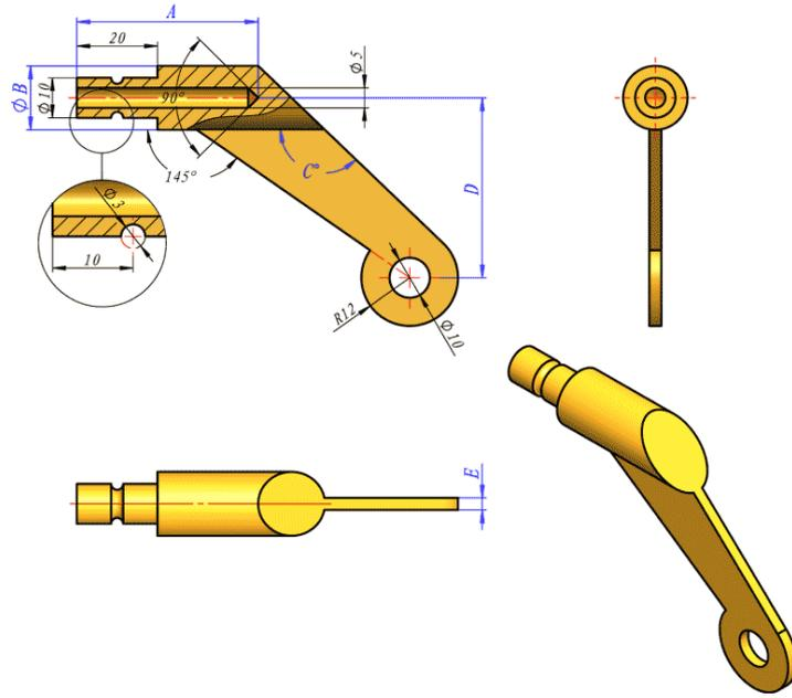
3、参照下图构建立体模型，请注意其中孔均为贯穿孔。请问模型体积为多少？
